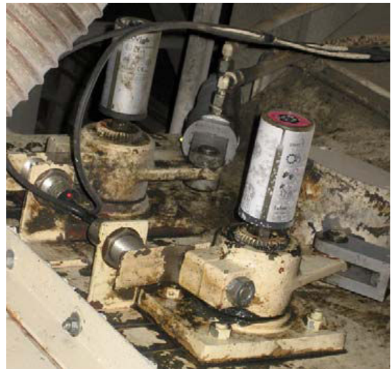
BESLUX LUBE en la lubricación de una unidad de transmisión.
