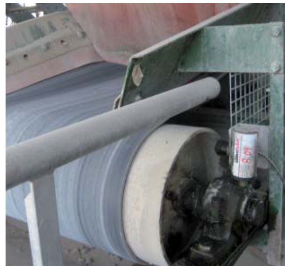
BESLUX LUBE lubricando el cojinete del rodillo de inversión de una cinta transportadora.
