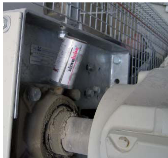
Un dispensador BESLUX LUBE de 125 ml engrasa el cojinete de brida de un eje de transmisión.
